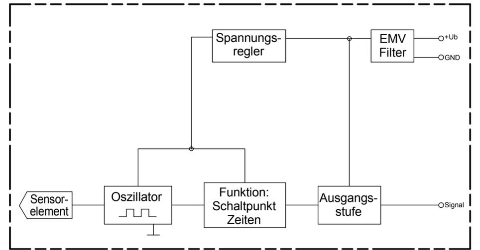
**Funktionsdiagramm für MAXIMUM Sonden**
