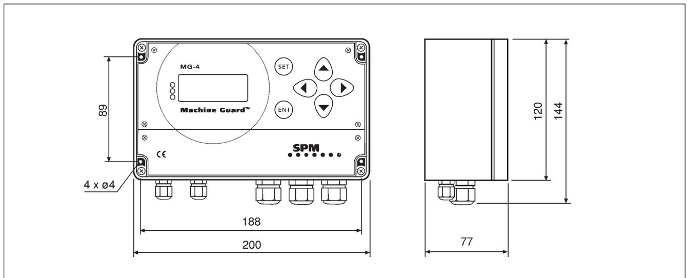
Der Machine Guard MG4-2A ist eine freistehende Messeinheit für die Dauerüberwachung von Maschinenschwingungen auf zwei Kanälen. Er misst die Schwingstärke (echter Effektivwert der Schwinggeschwindigkeit) gemäß ISO 10816.
