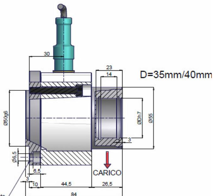
**Applicazioni:** misura del tiro di nastri, tessile, carta, laminati metallici, nylon, macchine flessografiche, macchine sviluppo fotografico ecc.
